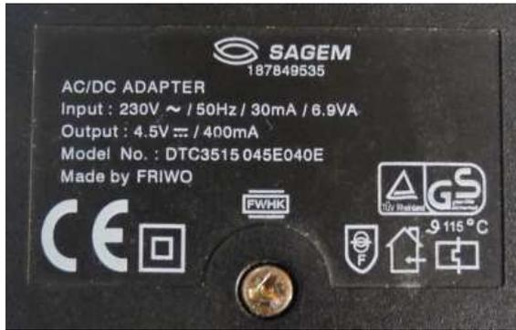
Plaque signalétique du chargeur de la batterie du téléphone portable
